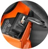
Automatische, in den Steuerhebeln integrierte Feststellbremse
